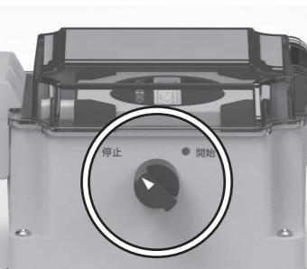
2 切替スイッチを開始から停止に回してから防滴ケースの蓋を開けてください。
