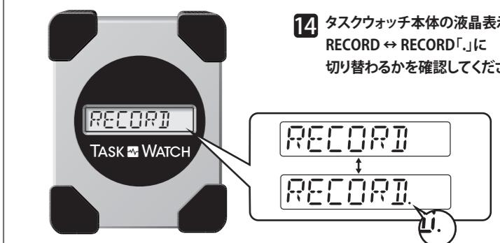
14 タスクウォッチ本体の液晶表示がRECORD ⇄ RECORD「」に切り替わるかを確認してください。
