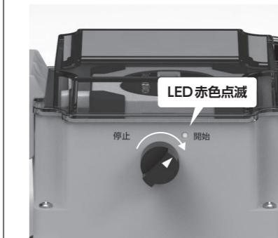
13 防滴ケースの切替スイッチを開始の位置に回しLEDが赤色点滅していることを確認してください。
