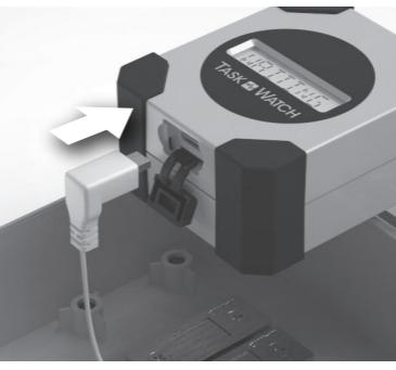
11 防滴ケースの内部にあるL型のUSB操作ケーブルをタスクウォッチ本体に接続します。
